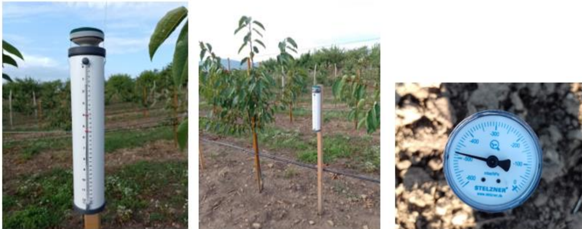
Figura 19. Evapotranspirometru Specmeters „ ET-gauge” și tensiometru sol-verificare umiditate sol
